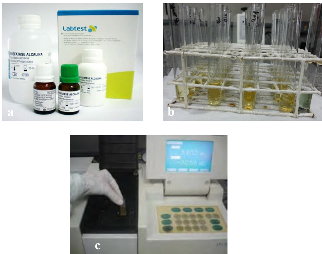
Figura 7 – Atividade da fosfatase alcalina. a) kit comercial Labtest; b) tubos de ensaio contendo os reagentes e as alíquotas; c) espectrofotômetro no comprimento de onda de 590 nm.
