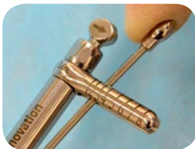
20. Devido ao projeto e desenho do hexágono do Implante BioDIRECT , o torque aplicado para a instalação não deve ultrapassar 80N, evitando assim danos permanentes ao hexágono do implante e impossibilitando assim a confecção da prótese posteriormente.
